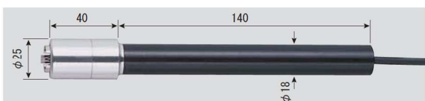
●SK-S301K 静止表面用 (中温) 0~600°C 先端部φ25×L40mm コード1.1m付 No. 8080-50 ¥14,700 (税抜き) (センサ精度 クラス2)
