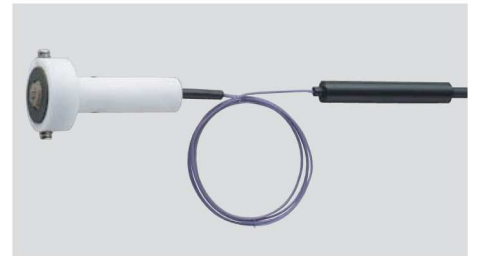
●SK-S403K 静止表面用 (マグネット型) 0~200°C 先端部φ30×R12mm 取っ手部φ15×L50mm コード1.1m付 ¥20,200 (税抜き) (センサ精度 クラス2)
